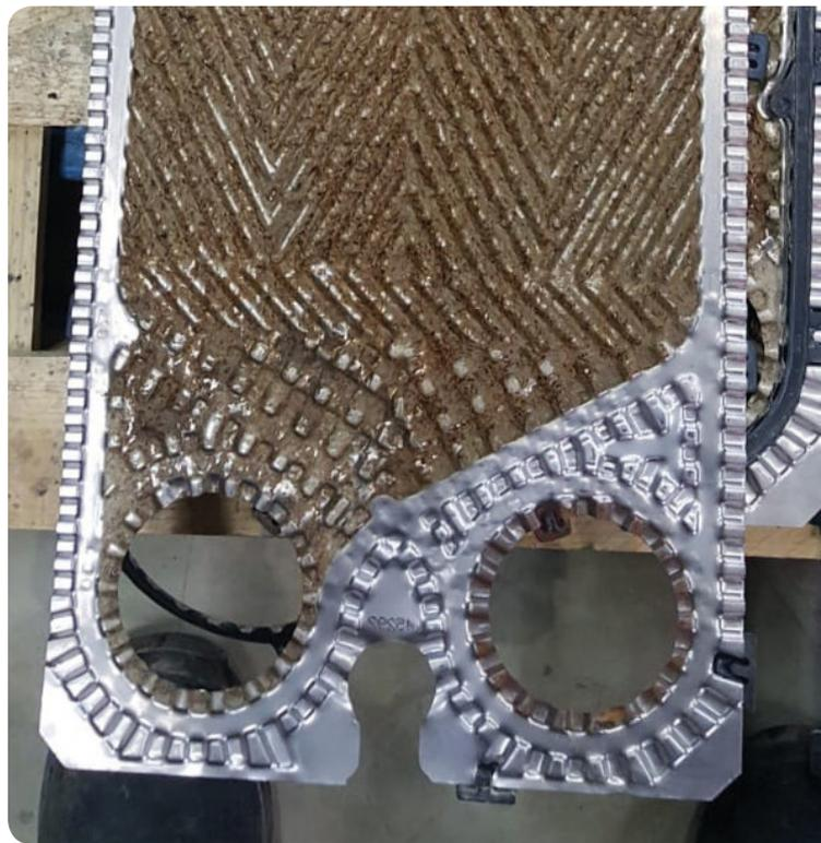
Beläge an Platten aus Wärmetauschern mindern deren Leistungsfähigkeit – die Pumpenleistung muss steigen oder die Zykluszeit verlängert sich. (Bild: ONI)
