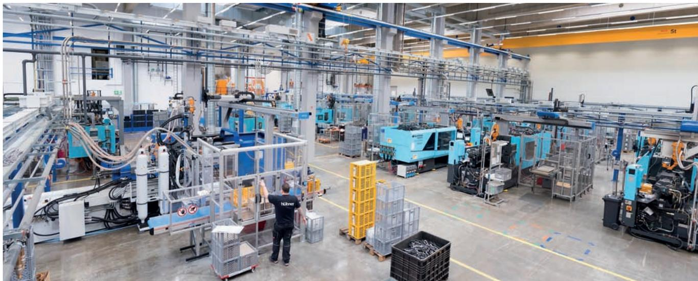
Der thermische Nutzungsgrad der Wärmerückgewinnung in der Kunststoffspritzerei erreicht Werte bis zu 80 Prozent.
