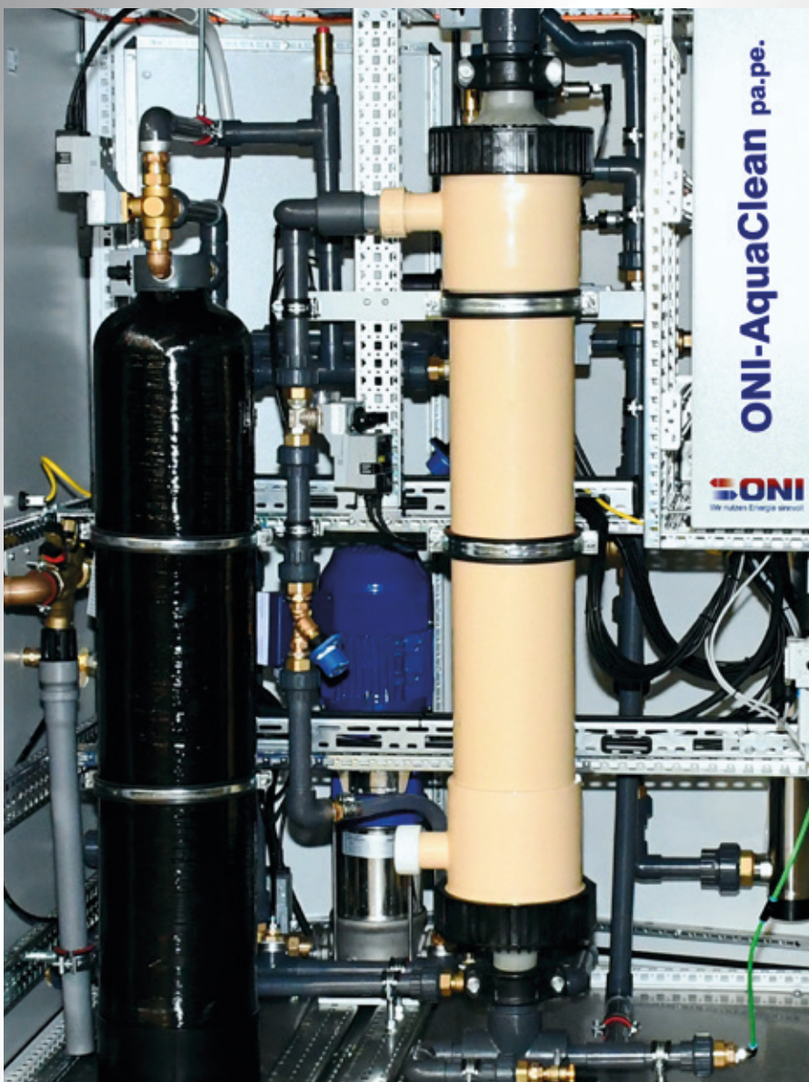
Blick auf die mehrstufige Filtereinheit mit rückspülbarem AFM- und Ultra-Feinstfilter.
