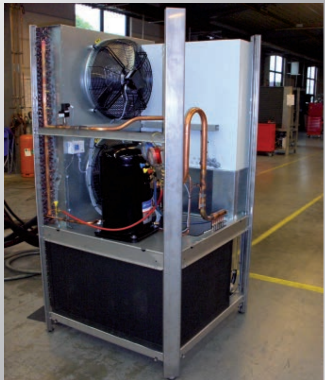
Kältemaschine in der Abschlussprüfung vor der Endmontage Chiller under final test prior to final installation
