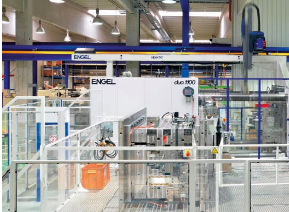
Die erste Duo 1100 WPX einschließlich der Automatisierungstechnik während des Einfahrens, davor der Werkzeugwechseltisch Famox für Formen bis 25 Tonnen und Umrüstzeiten von 6 Minuten. Die zweite, baugleiche Maschine wurde anschließend im Vordergrund, am Standplatz des Fotografen, aufgebaut, so dass der Werkzeugwechseltisch beide Maschinen bedienen kann. Inzwischen ist die Gesamtanlage komplett installiert und in Betrieb genommen.
